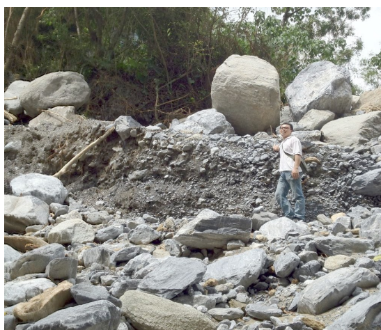
照片 2：中段可見一剖面，大顆粒在上，細砂泥流在下，符合土石流大型石塊漂流在上的典型。
